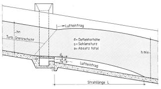
b)Lufzufuhr durch Hohlraum nach Absatz und seitlichem Schacht oder Wandabsatz.
