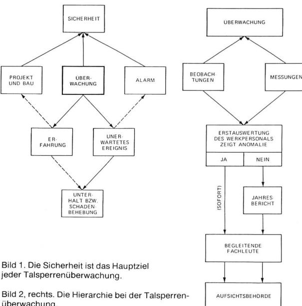
Bild 1. Die Sicherheit ist das Hauptziel jeder Talsperrenüberwachung.
