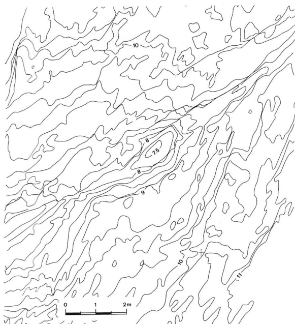
Bild 7. Ausschnitt aus den Vertikalschnitten beim Gierner Crest (Hohenrätien). Aufnahme mit Wild P 31: Basis etwa 8,5 m und Distanz etwa 45 m. Analytische Auswertung mit Wild BC 1: Äquidistanz der Kurven 25 cm; mittlerer Koordinatenfehler in der Projektionsebene nach äusserer Orientierung auf 9 Passpunkten: \pm 6 mm. Window-Plot ab Tape mit Aviotab Ta 2.
