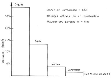
Figure 8. Répartition des barrages par type.
