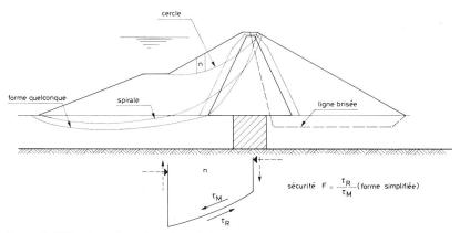
Figure 10. Différentes surfaces de rupture admises.
