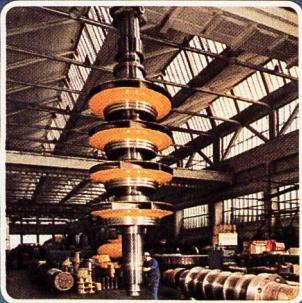
**Peltonturbine** Sellrain-Silz (A) mit 260000 kW Einheitsleistung bei 1237 m Fallhöhe.
