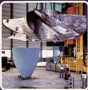
Rotor der **Speicherpumpe** von Roncoval-grande (I) von 92086 kW Leistung bei 757,5 m Förderhöhe.
