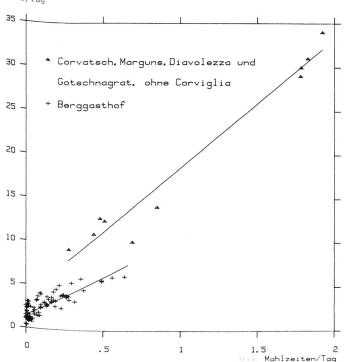
Diagramm 4. Tägliche Schmutzwassermengen in Funktion der abgegebenen täglichen Mahlzeiten. Vergleich des untersuchten Berggasthofes mit Werten anderer Ausflugsgaststätten.
