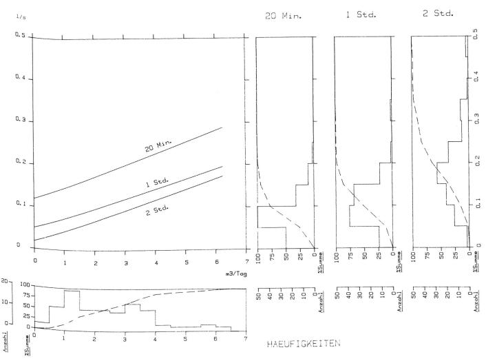
Diagramm 9. Schmutzwasseranfall in einem Berggasthof, Spitzenwerte (20 Minuten, 1 und 2 Stunden) in Funktion der Tagesmittel. Rechts die Häufigkeitsverteilungen und Summenkurven für die Spitzenwerte, unten die Häufigkeits- und Summenkurve für die Tagesmittel.
