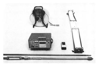
Bild 3. Das Gleitmikrometer ISETH mit Ablesegerät, Kabelrolle und Eichvorrichtung.
