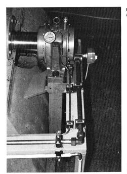
Bild 5, links. Zustand neu, Festlager auf Seite Turbine.
