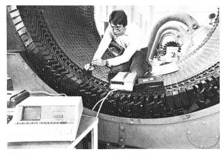
Bild 5. An einem Generator-Ständer wird anlässlich einer Inspektion mit elektronischen Messgeräten überprüft, ob die Kupferwicklungen auch gut in den Nuten sitzen. (Bild BBC)
