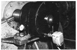
Bild 3. Zustand alt, Festlager auf Seite Turbine,
