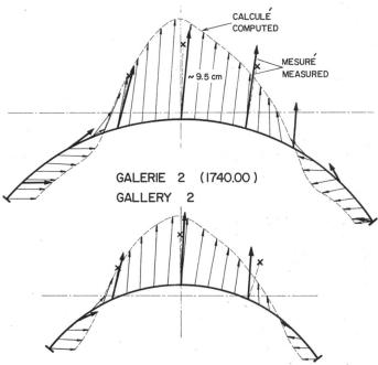
Figure 4. Barrage à l'état actuel fissuré. Déplacements mesurés et calculés.
