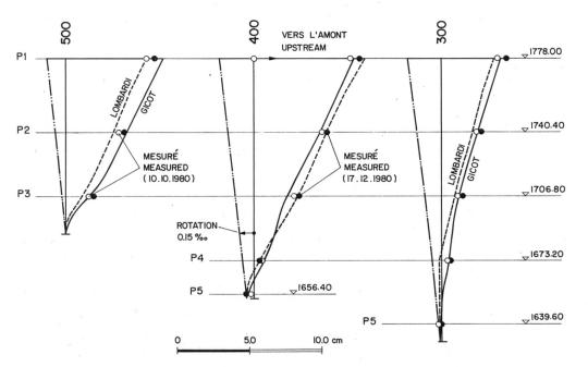
Figure 3. Barrage à l'état actuel fissuré. Confrontation des déplacements mesurés et calculés.
