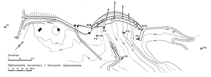
Figure 1. L'ancien réseau de triangulation et les déplacements horizontaux entre 1972 et 1979.
