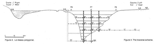
ditionnels furent construits en aval et en amont du barrage où la topographie et la géologie le permettaient. L'observation des angles horizontaux et verticaux fut complétée par des mesures de distance de précision avec le Mekometer ME 3000.
