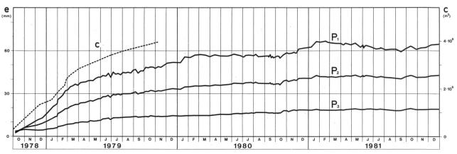
Figure 5. Evolution des écarts e entre déformations radiales calculées et mesurées d'octobre 1978 à décembre 1981 (console de gauche) et courbe des venues d'eau cumulées c dans la galerie du Rawil.
