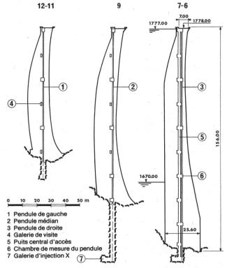
Figure 4. Coupes en travers du barrage au droit des pendules.
