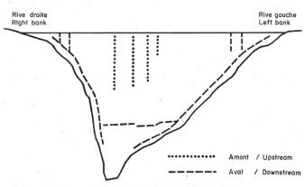
Figure 4. Fissures principales et ouverture des joints verticaux.
