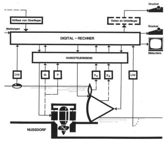
Bild 3. Blockschema des Kraftwerks Nussdorf.
