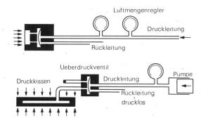
Bild 3. Oben pneumatisches System.
