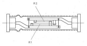
Bild 4. Messung mit einem Widerstandsdraht.
