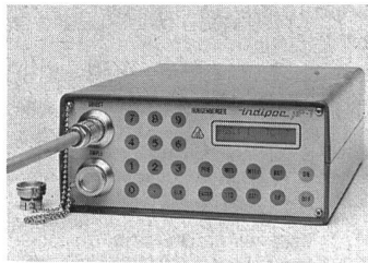
Bild 5. Mobiler Mess-Computer zur Aufnahme aller elektrischen Signale der Geber mit direkter Anzeige der gemessenen Werte.
