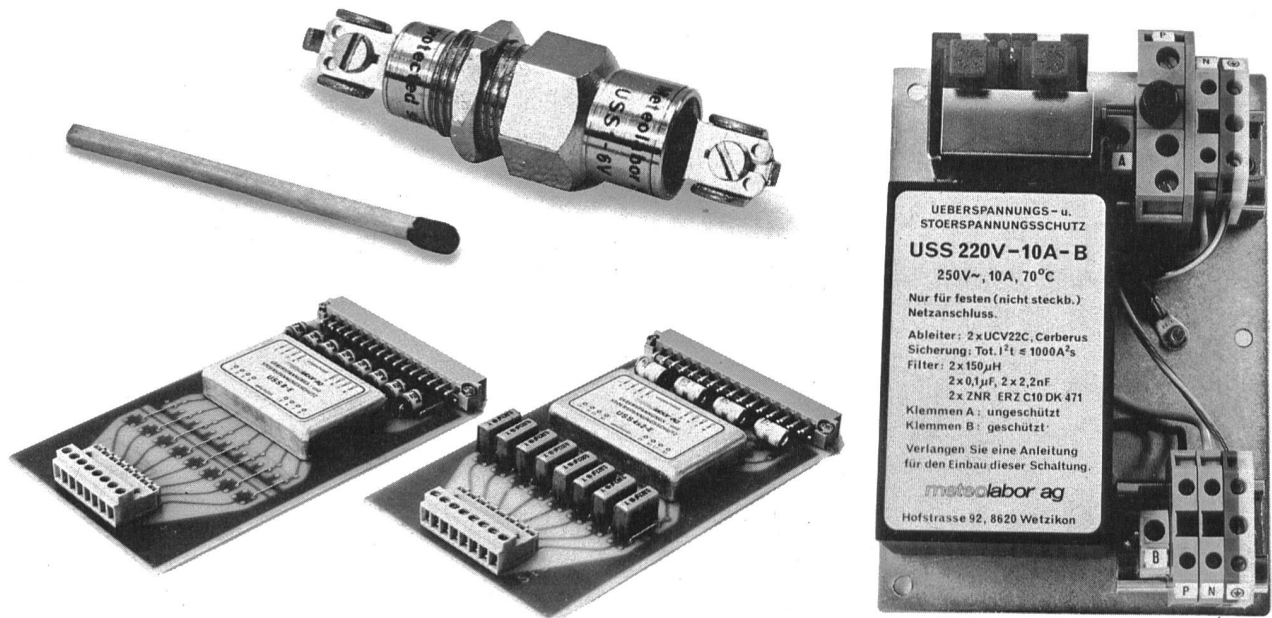
Bild 4. Im Handel erhältliche Schutzschaltungen (Werkbilder Meteolabor). Links oben: Durchführungs-Schutzschaltung, Betriebsspannung 6/12/24/150 V, Ableitstrom 25 kA (Form 8/20), Restspannung bei Überspannung <2 \times Betriebsspannung. Links unten: Schutzschaltungen für acht unabhängige Signalleitungen und für vier Doppeladern auf Europakarten. Rechts: Schutzschaltung für 220 V~/10A, Ableitvermögen 25 kA (Form 8/20).
