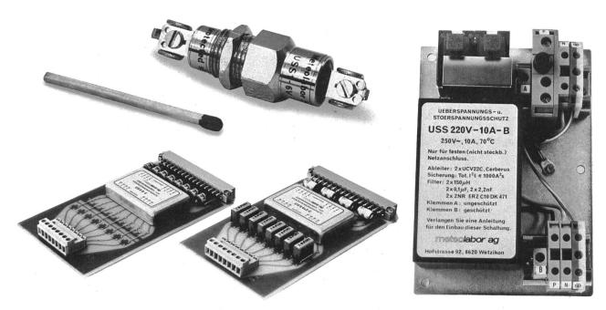
Bild 4. Im Handel erhältliche Schutzschaltungen (Werkbilder Meteolabor). Links oben: Durchführungs-Schutzschaltung, Betriebspannung 6/12/24/150 V, Ableitstossstrom 25 kA (Form 8/20), Restspannung bei Überspannung <2× Betriebsspannung. Links unten: Schutzschaltungen für acht unabhängige Signalleitungen und für vier Doppeladern auf Europakarten. Rechts: Schutzschaltung für 220 V~/10A, Ableitvermögen 25 kA (Form 8/20).
