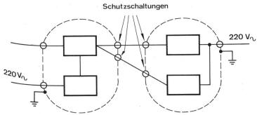
entsteht. Bild 6 zeigt in schematischer Darstellung die möglichen Kopplungsarten. Werden bei einer Anlage einzelne nah beieinander angeordnete Anlageteile zu Gruppen gebildet, so gilt die Regel, dass alle Drahtverbindungen, welche einen um die Gruppe herum gezeichneten Kreis durchbrechen, mit Schutzschaltungen oder Ableitern gegen die Gruppenerde geschützt werden müssen (Bild 7).
