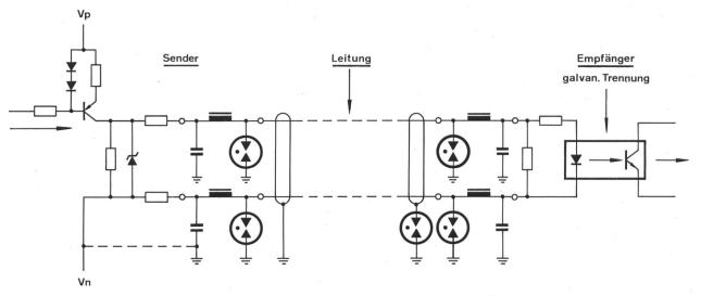
Bild 5. Datenkanal mit galvanischer Trennung vor dem Empfänger und beidseitig eingebauten Schutzschaltungen.
