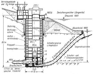
Bild 2. Als Schachtkraftwerk ausgeführtes Pumpspeicherkraftwerk Kühtai mit zwei Maschinensätzen (600 min<sup>-1</sup>). Längsschnitt.
