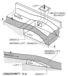
Bild 2. Belüftungsdispositiv für eine Schussrinne: Der vom Absatz erzeugte Strahl reisst auf seiner Unterseite Luft mit, die durch die Belüftungsschächte seitlich zuströmt (Prinzip der Wasserstrahl-Luftpumpe).
