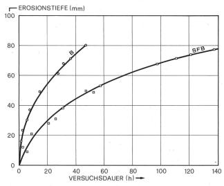
Bild 5. Kavitationswiderstand von Betonplatten nach [9]. Abhängigkeit der Erosionstiefe von der Versuchsdauer. Kurve B für gewöhnlichen Beton mit einem Zementgehalt von 356 kg/m³. Kurve SFB für stahlfaserverstärkten Beton mit einem Zementgehalt von 418 kg/m³ und einem Fasergehalt von 83 kg/m³.
