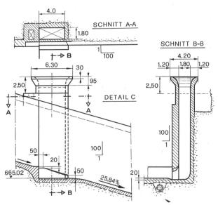
Bild 3. Hochwasserentlastung Foz do Areia, Brasilien. Oben: Längsschnitt und Situation. Unten: Details der Belüftungsschächte und der Absätze (aus [6]).
