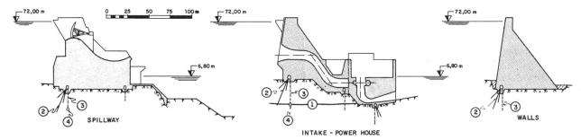
Bild 3a. Querschnitte durch Betonstrukturen. Links Hochwasserentlastung, Mitte Einlaufwerk-Zentrale, rechts Anschlussmauer Beton/Damm.
