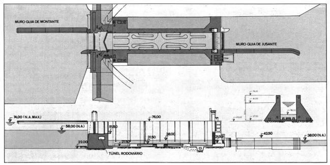
Bild 4. Obere Schiffahrtsschleuse, Situation, Längs- und Querschnitt. In den voluminösen Teilen der über 50 m hohen Gewichtsmauern beidseits der Schleusenkammer (33 × 210 m) sowie in den Übergangsmauern an die beiderseits der Schleuse anschliessenden Erddämme wird «Rollcrete» eingebaut.
