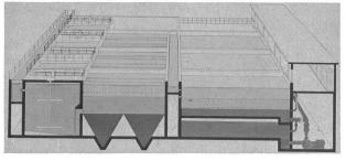
Das Schema (Bild 2) veranschaulicht die gewählte Verfahrenskombination. Der Baukörper wurde bereits für eine totale Durchsatzleistung von 800 m³/h erstellt, doch erfolgte dessen Ausrüstung für den gegenwärtigen Bedarf von 400 m³/h.
