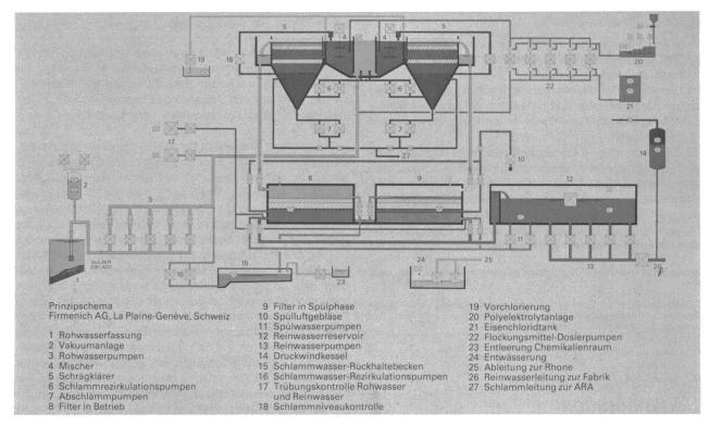
Bild 2. Flusswasser-Aufbereitungsanlage für Industriewasserversorgung Firmenich AG, La Plaine-Genève.
