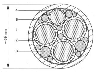
Bild 2. Energiekabel 1 kV,  $3 \times 300 + 150 \text{ mm}^2$ . 1 Verseilter Kupferleiter; 2 EPR-Isolation; 3 EPR-Beilauf; 4 Umwicklung aus Glasfaserbändern; 5 Oranger EPR-Mantel.
