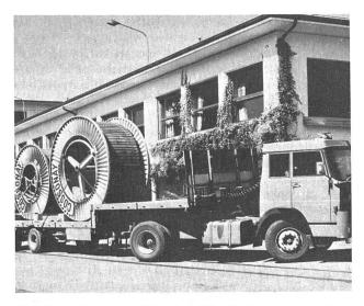
Bild 3. Strassentransport der Kabelrollen mit über 3 m Durchmesser auf einem Tiefladeanhänger.
