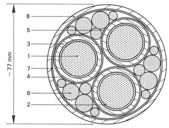
Bild 1. 10-kV-Kabel 3 × 300 mm². 1 Verseilter Kupferleiter; 2 Extrudierter Halbleiter; 3 EPR-Isolation; 4 Abschälbarer Halbleiter; 5 Schirm aus Kupferbändern; 6 EPR-Beilauf; 7 Umwicklung aus Glasfaserbändern; 8 Roter EPR-Mantel.
