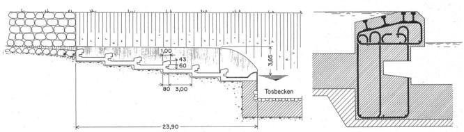
Bild 5, links. Längsschnitt durch den Fischaufstieg in der Albula mit den wichtigsten Abmessungen.
