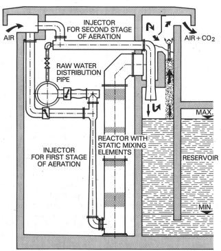
Bild 3. Schema der zweistufigen Entsäuerungsanlage.
