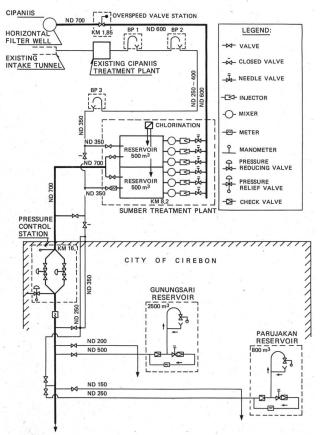
Bild 1. Hydraulisches Schema des Wasserversorgungssystems.
