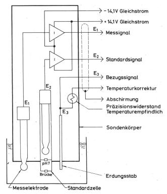
Bild 5. Schematische Darstellung der pH-Messung mit einem Differential-Messverfahren.
