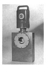
Bild 7. Trübungs-Streulicht-Messgeber mit kontinuierlicher Linsenreinigung.
