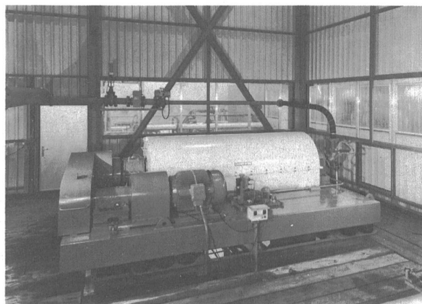
Bild 1. Zentrifugaldekanter Typ ZDC-100 mit 1000mm Trommeldurchmesser von Escher Wyss.
