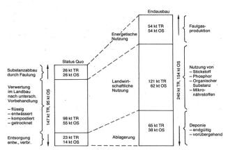
Bild 1. Entwicklung der jährlichen Frischschlammengen bis zum Endausbau sowie die Anteile der Bewirtschaftungsarten in kt Trockenrückstand (TR) und kt organische Substanz (OS).
