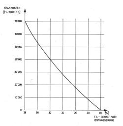
Bild 5. Kalkkosten in Funktion der Entwässerungsleistung. Randbedingungen: Geforderter Endgehalt nach der Konditioniserung 40% TS. Kalkpreis 170 Franken/t CaO.
