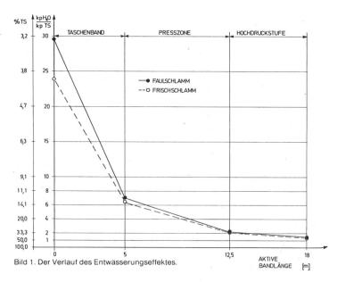
der Siebbandpressentechnik zu setzen. So stehen heute Voest-Alpine-Siebbandpressen im Betrieb, die kommunale Schlämme bis auf über 35% Feststoffgehalt entwässern. Solche Schlämme lassen sich anschliessend ohne Zusatzenergie verbrennen.
