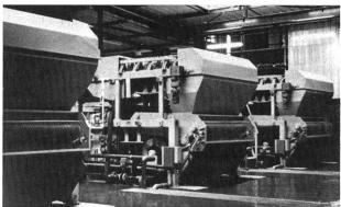
Bild 3. Siebbandpressen mit Taschenband und Hochdruckstufe.
