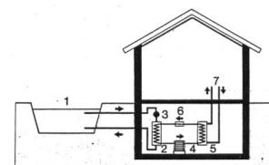
Wegen der äussern Verschmutzung der Verdampfer werden diese nicht direkt in das Oberflächengewässer montiert, sondern das Wasser wird, wie bei der Nutzung des Grundwassers, durch den im zu heizenden Haus aufgestellten Verdampfer gepumpt.
