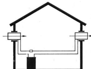
Aus Lüftungsanlagen zurückgewonnene Wärme kann der Zuluft und aus Abwasser zurückgewonnene Wärme dem betreffenden Frischwasser wieder zugeführt werden. Niedertemperaturige Abwärme aus hochtemperaturigen Industrieprozessen wird meistens für die Heizung und die Warmwasserbereitung eingesetzt.
