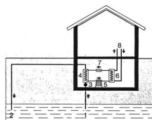
In der Regel wird das Grundwasser durch den Verdampfer der Wärmepumpe um etwa 4°C abgekühlt. Für ein Einfamilienhaus mittlerer Grösse muss durch den Verdampfer, je nach Aussentemperatur und Auslegung der Anlage, 1 bis 2 l/s Grundwasser gepumpt werden. Es muss nach der Abkühlung wieder in den Grundwasserstrom zurückfließen. Eine Verschmutzungsgefahr besteht kaum.
