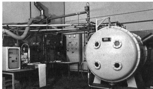
Das Gas Ozon wird heute industriell hergestellt, und zwar nach dem Prinzip der «stillen elektrischen Entladung». Mit einem Kilogramm Ozon kann eine Wassermenge von bis zu 1000 m<sup>3</sup> behandelt werden. Durch die Optimierung und Automatisierung der BBC-Verfahrenstechnik einerseits und die Reduktion der Ozon-Herstellungskosten durch Verwendung neuer Technologien andererseits sind die Voraussetzungen für den wirtschaftlichen Einsatz im grossen Stil geschaffen.
