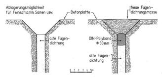
Bild 1. Instandsetzung der Fugendichtungen im Werkkanal der Rheinkraftwerk Albbruck-Dogern AG, RADAG. Links im Schnitt die alte Fugendichtung, rechts die sanierte Fugendichtung.
