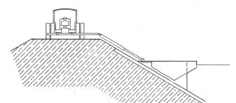
Bild 4. Schnitt durch die Kanalböschung mit dem kleinen Stahlkasten zur Sanierung der Betonplatten. Auf der Dammstrasse steht der Traktor des Arbeitszuges. Gleicher Massstab wie Bild 3.
