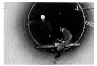
Bild 8. Schichtdickenmessung in Druckrohrleitung.
