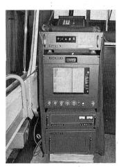
Bild 5. Das Echolot-Gerät ist im Messboot der EDF eingebaut.
