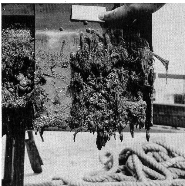
Bild 6. Bewuchs an beschichteten Musterplatten.
