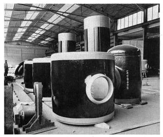
Bild 5. Mit PUR-Teer beschichtete Pipeline-Rohre. (Werkfoto TIB, Mannheim)
