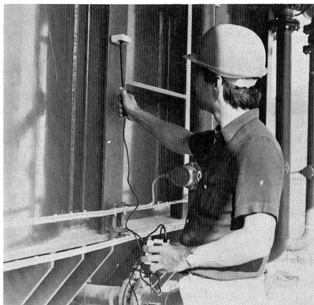
Bild 9. Porenkontrolle mittels Pin-Hole-Detektor.
