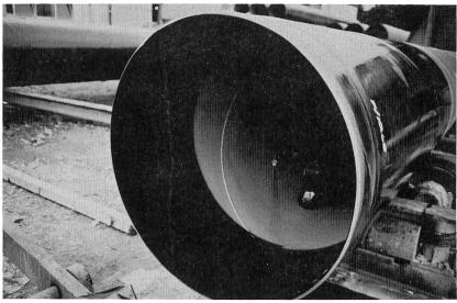
Bild 2, links. Verteilrohrleitung und Kugelschieber eines Hochdruckkraftwerkes mit Chlorkautschuksystem geschützt.
