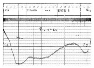
Bild 2. Staustufe Kembs, Oberer Vorhafen der Schleusen. Querprofil bei Kanal-km 4,72, Echolot-Aufzeichnungen. Die Distanz zwischen zwei vertikalen Linien entspricht 10 m. Das Profil ist 10mal überhöht. RG linkes Ufer; RD rechtes Ufer.
