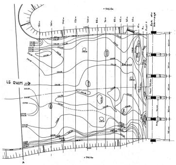
Bild 3. Wehr Kembs, Sohlenplan, nach Echolotaufnahmen gezeichnet.
