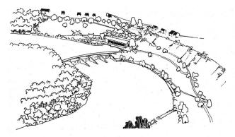
Bild 9. Rheinkraftwerk Rheinau, Ansicht flussaufwärts [5]. Das Maschinenhaus steht am Einlauf des Triebwasserstollens; es wurde harmonisch in die Landschaft eingeplant. Das Stauwehr ist im Grundriss leicht gekrümmt, damit es im stark gekrümmten Fluss optisch weniger stört.
