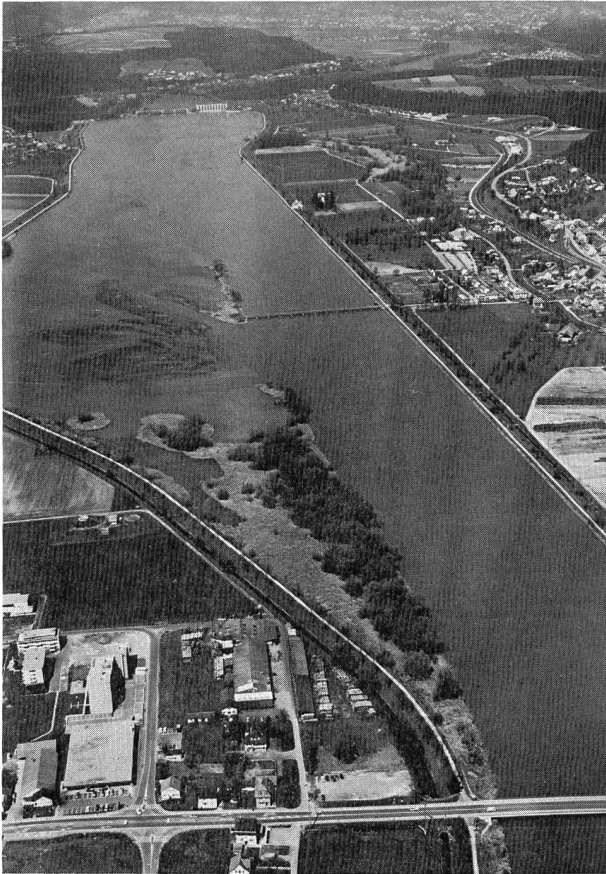
Bild 2. Aarestausee Klingnau, Blick flussabwärts. Ablagerung von Feststoffen in Form von Sandbänken (Foto Comet 1975).
