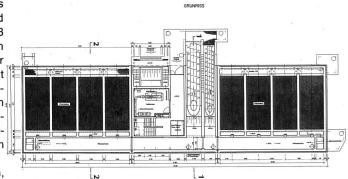
Bild 4. Grundriss mit Schnittspuren 1 und 2 der Abwasserfiltrationsanlage; 4 Reinigungsstufe.
