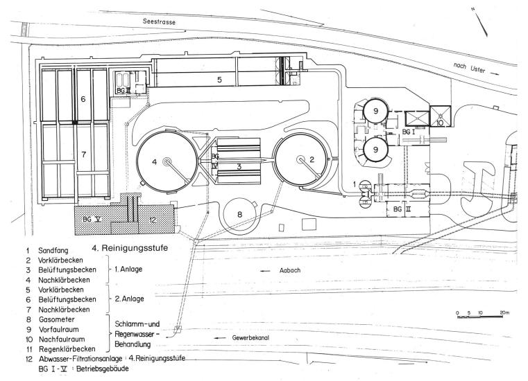
Bild 3. Erweiterung der Kläranlage Niederuster. Übersichtsplan.
