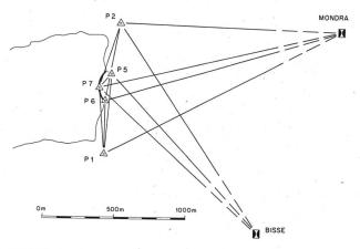
Bild 6. Für die Minimessung werden nur die Distanzen P1 bis P2 und P6 bis P5 sowie die radiale Lageänderung von P7 in der Mitte der Staumauerkrone gemessen.
