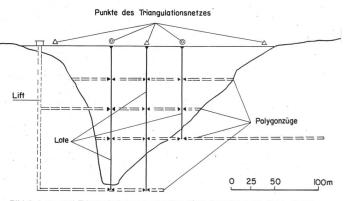
Bild 3. Lote und Triangulationsnetz werden über Ausgänge an der Luftseite der Staumauer oder über die Mauerkrone miteinander verbunden.
