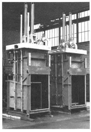
Geliefert werden Anlagen bis 2 m² Durchlassquerschnitt bei kleineren Stauhöhen und 50 m Stauhöhe bei kleineren Durchlassquerschnitten.
