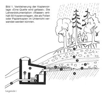
1) Humus, 2) Kies und Sand, 3) Sand, 4) Lehm oder Fels, 5) Wasser, 6) Steinschicht, 7) Sickerröhre, 8) Brunnenstube, 9) Sieb, 10) Absperrhahn, 11) Zuleitung Reservoir
