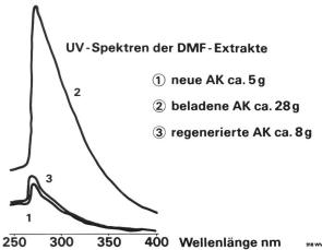
Bild 44. Resultat der Aktivkohle-Regenerierung. UV-Spektren der DMF-Ex-
