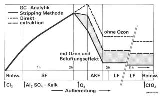
Bild 51. Haloforme im Aufbereitungsprozess des Seewasserwerks Lengg. GC steht für Gaschromatographie
