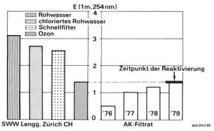
Bild 46. Reduktion der UV-Extinktion während der Wasseraufbereitung, Jahresmittel 1976/1979.
