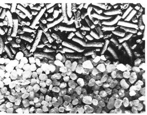
Bild 41. Zweischicht-Aktivkohlefilter. Unten die Stützschicht aus Quarzsand, Durchmesser 1 bis 2 mm, oben die Aktivkohle.
