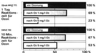
0 50 Bild 37. Verminderung der Haloforme durch Ozonung des Wassers.
