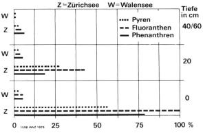
Bild 5. Polyzyklische Aromate in verschiedenen Schichttiefen des Sedimentes (Walensee und Zürichsee).
