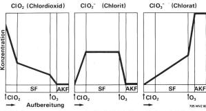
Bild 21. Seewasserwerk Lengg der Stadt Zürich. Voroxidation mit Chlordioxid: Bildung von Chlorit und damit von Chlorat.
