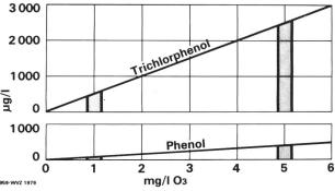
Bild 35. Reduktion von Trichlorphenol und Phenol durch Ozon in Funktion der Zugabemengen.
