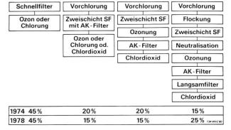
Bild 15. Die Wasseraufbereitungsverfahren der 36 schweizerischen Seewasserwerke (1978).
