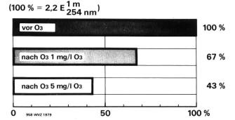
Bild 34. Reduktion der UV-Extinktion durch Ozon bei verschiedenen Ozonkon-
