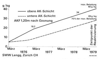
Bild 47. Beladung der oberen und der unteren Aktivkohleschicht in g/kg Dimethyl-Formamid und Dioxan-Extrakt in Funktion der Zeit.
