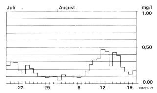
Bild 54. Display-Diagramm der Restozonmengen (Tagesmittel) im Juli und August 1979
