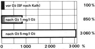
Bild 36. Zunahme der Aldehyde nach Ozonung des Wassers
