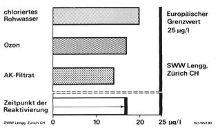
Bild 45. Halogenisierte Kohlenwasserstoffe im Rohwasser und im Trinkwasser der Stadt Zürich.
