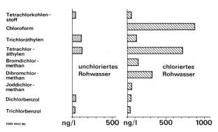
Bild 19. Neubildung bzw. Erhöhung von Halogenverbindungen durch Chlor.
