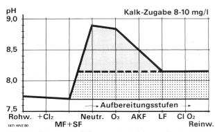
Bild 27. Veränderung des ph-Wertes durch den Wasseraufbereitungsprozess im Seewasserwerk Lengg. Vom Rohwasser bis zum Reinwasser durchläuft das Wasser die folgenden Stufen: Vorchlorierung ( $\mathrm{Cl}_2$ ), Mikroflockulation (MF), Zweischicht-Schnellfiltration (SF), Neutralisierung (Neutr.), Ozonung ( $\mathrm{Cl}_3$ ), Aktivkohlefiltration (AKF), Langsamfiltration (LF), Netzschutz mit Chloroxid ( $\mathrm{ClO}_2$ ).
