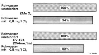
Bild 17. Reduktion in % des  ${\rm KMnO_4}$  und der UV-Extinktion durch Zugabe von 0,8 mg/l Cl, im Rohwasser.
