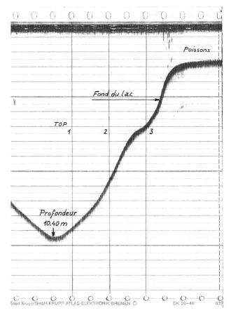
Figure 3. Exemple de bande d'écho-sondeur.
