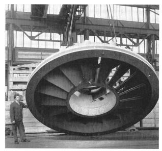
Bild 1. Leitapparat für das Kraftwerk Lechstufe 21.
