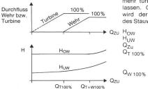
Über das Stauwehr wird der nicht mehr turbinierbare Zufluss abgelassen. Gemessen und geregelt wird der Wasserstand oberhalb des Stauwehrs, H<sub>OW</sub>.
