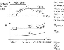
Mit dem Einlaufwehr wird der Wasserstand im Einlaufkanal H<sub>OW KW</sub>, begrenzt. Die Messstelle liegt unterhalb des Wehrs. Nicht mehr turbinierbarer Zufluss fliesst über die feste Schwelle im Flussbett ab.
