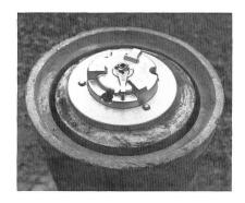
Bild 5a, links. Zentrierplatte in Pfeiler einbeto-
