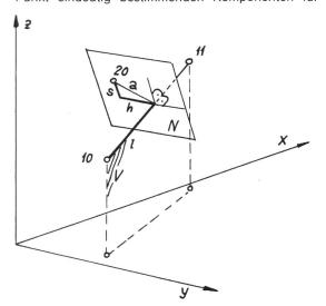
Bild 3. Lokales Koordinatensystem im Alignement. Der Punkt 20-wird durch die lokalen Koordinaten 1, h, s auf die Bezugsstrecke 10, 11 bezogen. Die Koordinaten h, s liegen in der Ebene N, die im Punkt 20 senkrecht auf die Strecke 10, 11 steht.
