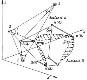
Bild 2. Unterschied zwischen Deformation und Verschiebung einer Struktur. Die Pfeile in den Punkten 10, 11, 12 zeigen die Verschiebungen beim Übergang vom Zustand A in den Zustand B, die schraffierten Flächen zeigen die Deformation von charakteristischen Kanten.
