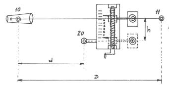
Bild 7a. Bestimmung der Abweichungskomponenten h (vgl. Bild 3) des Punktes 20 mit Hilfe einer Messspindel.
