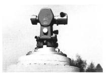
Bild 6b, links. Theodolit mit optischem Mikrometer. Auf dem Objektiv ist ein Planplattenmikrometer aufgesetzt. Es kann wahlweise zur Messung von Horizontal- oder Vertikalkomponenten von Verschiebungen verwendet werden.
