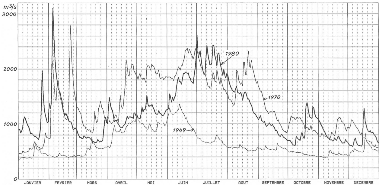
I Abflussmengen des Rheins bei Rheinfelden: Einzugsgebiet 34 550 km 2 , Vergletscherung 1,6%. Jahresabflussmenge 1935–1980 1027m 3 /s; Jahr 1980 1187 m 3 /s.
