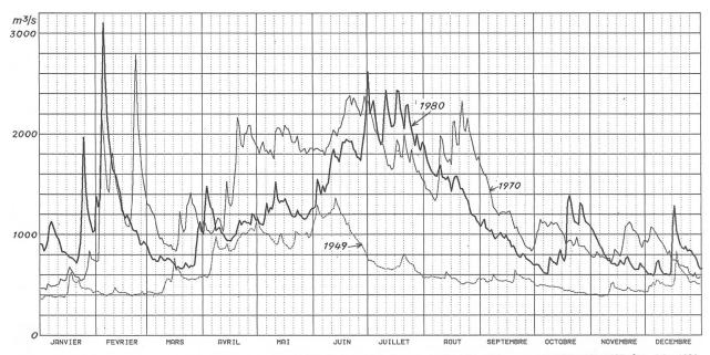
l Abflussmengen des Rheins bei Rheinfelden: Einzugsgebiet 34 550 km², Vergletscherung 1,6%. Jahresabflussmenge 1935–1980 1027m³/s; Jahr 1980 1187 m³/s.
