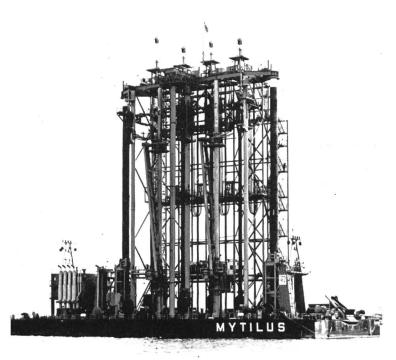
Bild 6. Aufnahme vom Vibrationsschiff. Länge 88 m, Breite 33 m, Höhe über Wasser 51 m.
