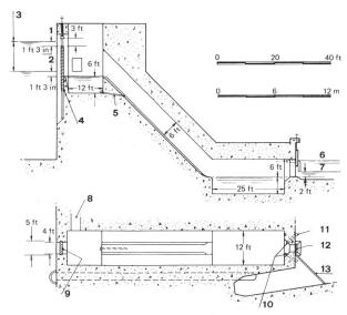
Bild 1. Anordnung eines Borland-Fischpasses. Schnitt, oben, und Grundriss
