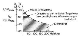
$\mbox{Bild 3.}$  Schematische Darstellung der bivalent-parallelen Betriebsweise von Raumheizanlagen.
