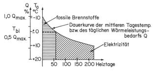
${\sf Bild~2.~Schematische~Darstellung~der~bivalent-} {\it alternativen~Betriebsweise~von~Raumheizanlagen.}$
