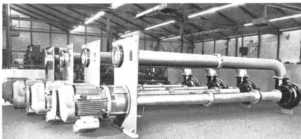
– Vertikale nassaufgestellte Turo-Pumpen in hochverschleissfester Ausführung mit hydraulischem Antrieb
