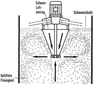
Bild 3. Submerser Umwälzbelüfter mit schaumabsaugendem Saugrohr.
