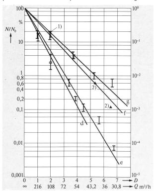
Bild 3 – Abtötungskurven für coliforme Keime
