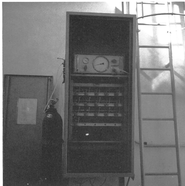
Bild 4. Messzentrale für 16 Porenwasserdruckgeber in der Staumauer Zervreila.
