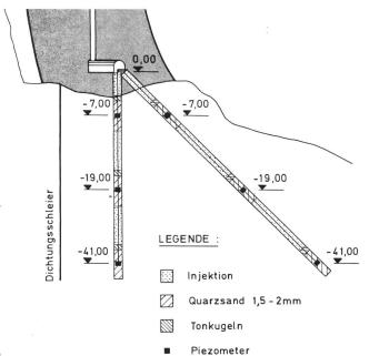
Bild 2. Bogenstaumauer Zervreila. Anordnung der Piezometer bei Block 8.
