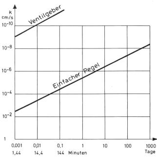
Bild 1. Abhängigkeit der Füllzeit des Piezmeterrohres von der Durchlässigkeit des Felsens.
