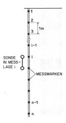
Bild 2. Gleitmikrometer ISETH. Messprinzip, Instrumentpositionen entlang einer Messlinie.
