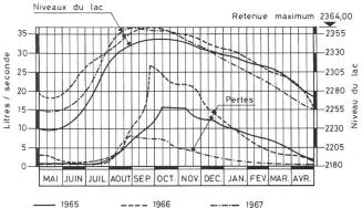
Figure 3. Débits d'infiltration sur rive gauche.
