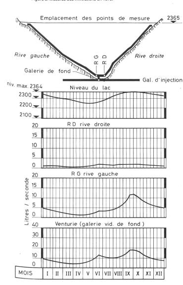
– Le tableau 1 indique tous les emplacements où on mesure les débits d'infiltration. Il est à relever que les débits mesurés au Venturi, situé dans la galerie de vidange de fond, comprend les eaux de pluie et de fonte pouvant provenir du couronnement du barrage et des galeries de drainage. Ces venues sont appréciables au moment de la fonte des neiges.
