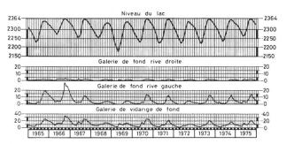
Figure 4. Mesure des infiltrations au pied du barrage.
