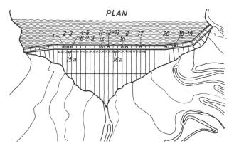
Figure 6. Situation des prises de pression pour les infiltrations dans les galeries et les puits
