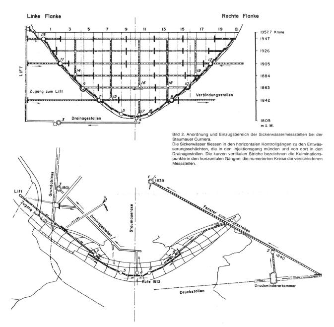
Die entlastende Wirkung dieser Stollen wird mit zunehmender Durchlässigkeit des Felsens verstärkt, weil die geringen durch den Dichtungsschirm sickernden Wassermengen in der anschliessenden, nicht injizierten Zone mit grossem Sickergefälle in die drainierenden Durchörterungen des Gebirges abfliessen können.
