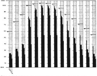
Bild 4. Auftriebsdrücke in den untersten Messquerschnitten bei der Gewölbemauer Sta. Maria während der 11. Stauperiode 1978/79.
